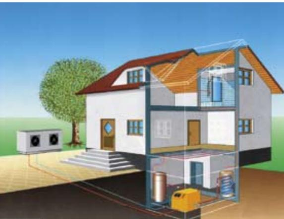
Luft steht immer und überall in unbegrenzter Menge zur Verfügung. Eine Luft/Wasser-Wärmepumpe nutzt diese Wärmequelle zum Heizen Ihres Hauses. Luft/Wasser-Wärmepumpen sind einfach zu installieren. Entweder werden sie in den Keller gestellt und über Zu- und Abluftführung mit der Außenluft verbunden, oder Sie setzen ein gesplittetes Gerät ein. Diese Anlagen werden bivalent oder mono-energetisch betrieben.
